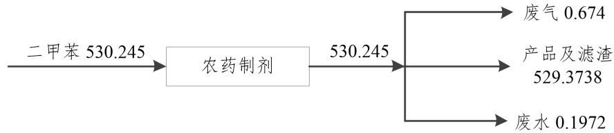
图 2-21 技改项目二甲苯平衡图（单位：t/a）
