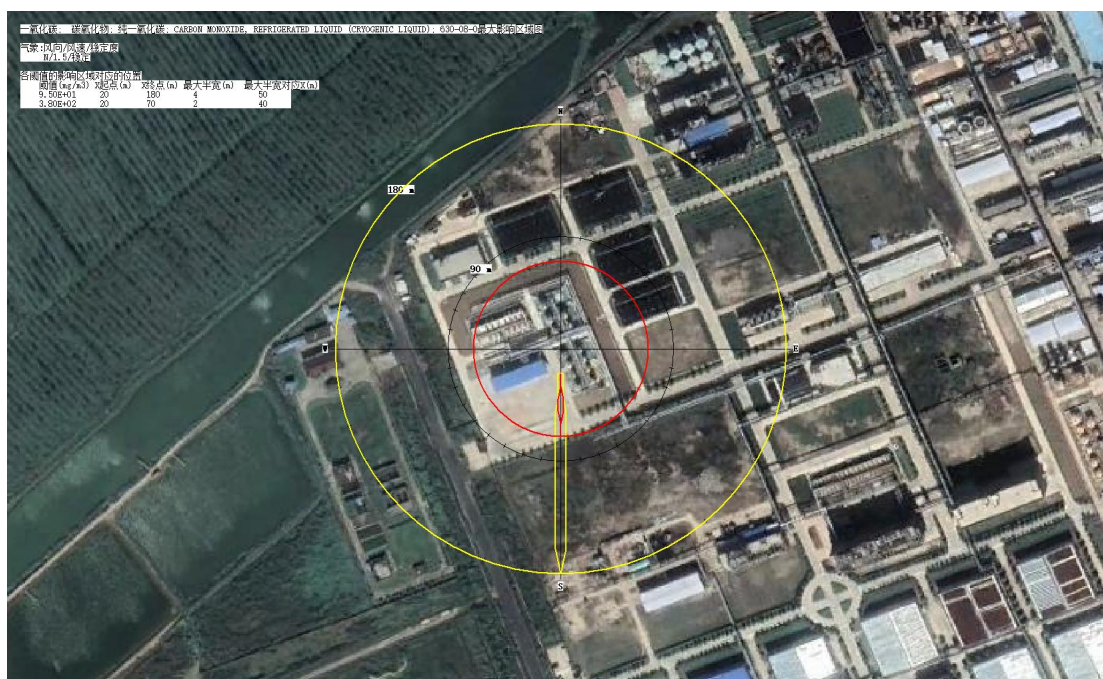
图 2 最不利气象条件 CO 超过阈值的最大轮廓线图
