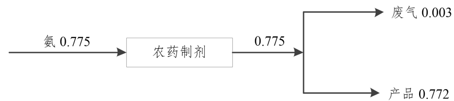
图 2-23 技改项目氨平衡图（单位：t/a）
